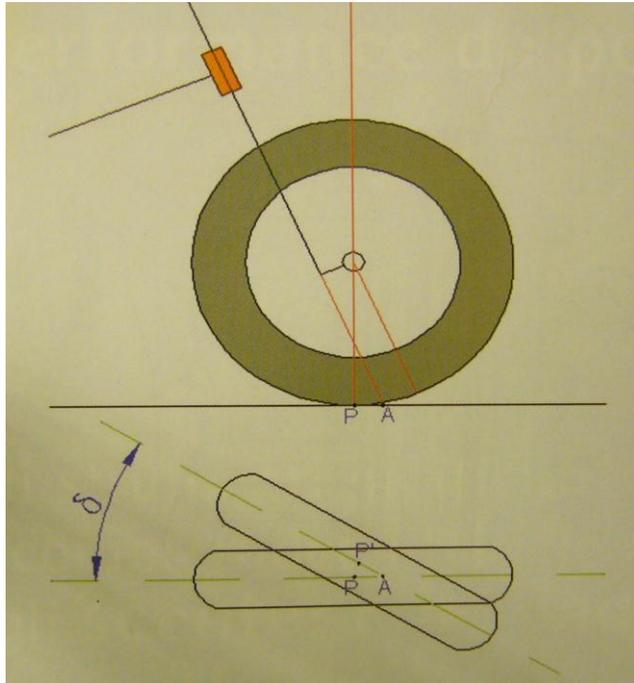
Con la ruota anteriore sterzata verso destra di un certo angolo  $\delta$  (ipotizziamo per semplicità l'angolo di rollio nullo), il punto di contatto della ruota al terreno si sposta a sinistra dell'asse longitudinale della motocicletta dalla posizione P alla posizione P'.
