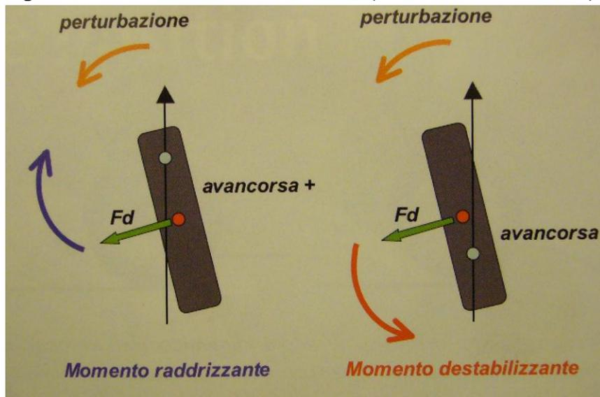
L'effetto raddrizzante è fondamentale per mantenere in equilibrio il veicolo durante la marcia in rettilineo. In questa immagine viene chiarificato il fenomeno, confrontandolo con l'effetto opposto destabilizzante. Il punto di intersezione dell'asse di sterzo con il piano stradale è colorato in azzurro mentre il punto di contatto ruota terreno è in rosso. Qualora questi punti dovessero coincidere si avrebbe un effetto indifferente.
