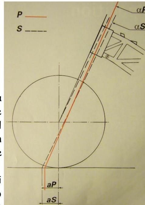
In alcuni motocicli è possibile variare leggermente l'avancorsa, questa possibilità viene data per offrire due configurazioni di guida della motocicletta senza modificare l'interasse. La geometria dello sterzo per uso stradale (S) è di  $24^{\circ} 30'$  per l'angolo di sterzo e 97 mm di avancorsa. Per l'impiego in pista (P) i valori cambiano in  $23^{\circ} 30'$  e 91 mm.
